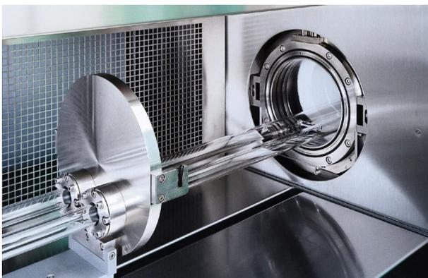
INO THERM fertigt die Reaktoreinheit in zwei Varianten. Gaseingangsseitig sind die Quarzrohre flanschlos in einem wassergekühlten Reaktorkopf befestigt. Die Gasausgangsseite wird gemäß Kundenwunsch und Prozessspezifikation wahlweise ausgeführt als:
