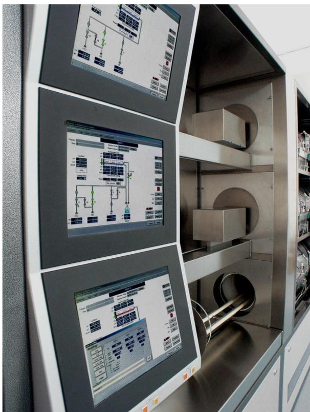
Das fest installierte Sicherheits- und Überwachungssystem verhindert anlagengefährdende Kombinationen. Ein umfangreiches Schlüssellevelsystem lässt die Zugriffsrechte auf Programme bis auf den einzelnen Prozessparameter mit Wertebereich sowie auf die Bedienung der Anlage definieren.
