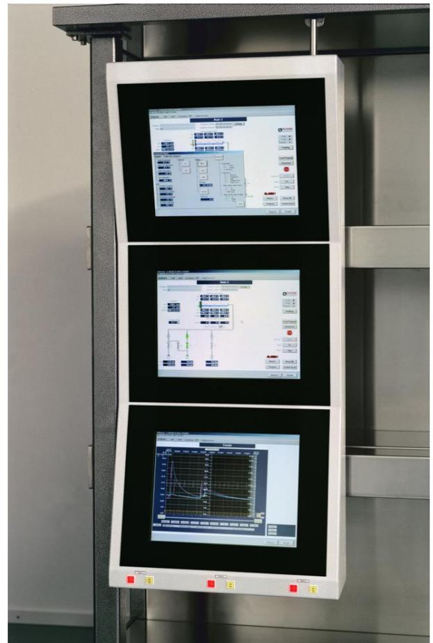
Die Steuerung basiert auf einer PC-Prozessor-Einschubkarte, die mit einem leistungsfähigen 32-Bit RISC Prozessor bestückt ist und einer unter MS-Windows lauffähigen Benutzeroberfläche, welche eine komfortable Bedienung, Programmierung und Visualisierung der Anlage bietet.
